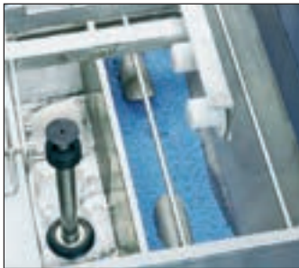
Granulaat zit in een aparte wastank , kan niet door de afvoer wegspoelen.
