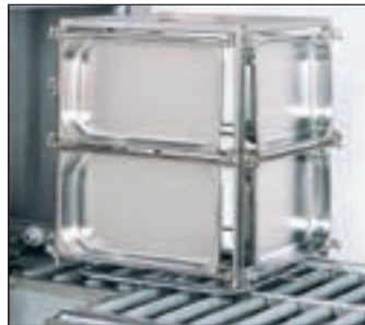
De cassette schuift gemakkelijk over de grote rollers van de aanvoertafel.
